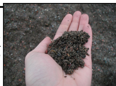
Unité de traitement des sables et sables lavés - STEP DOUAI
